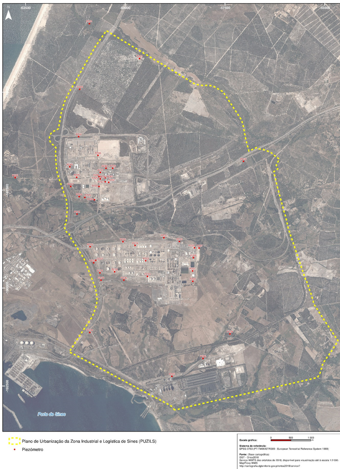
Figura 2 – Rede de Monitorização dos Recursos Hídricos Subterrâneos
